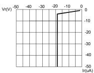
FIG.3 BLUE&GREEN REVERSE CURRENT VS. REVERSE VOLTAGE.
