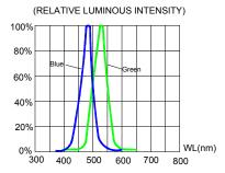
FIG.4 BLUE&GREEN RELATIVE LUMINOUS INTENSITY VS. WAVELENGTH.
